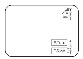
Mithos è un cronotermostato settimanale da parete elettronico che esegue azioni di tipo 1B con software di classe A ed è adatto ad ambienti con grado di inquinamento 2 e categoria di sovratensione III (EN 60730-1).
