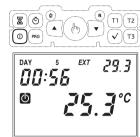
In funzionamento estivo invece la condizione di impianto spento esclude completamente il comando di refrigerazione. Per tornare al modo di funzionamento precedente allo spegnimento, premere nuovamente il tasto " (1) "
